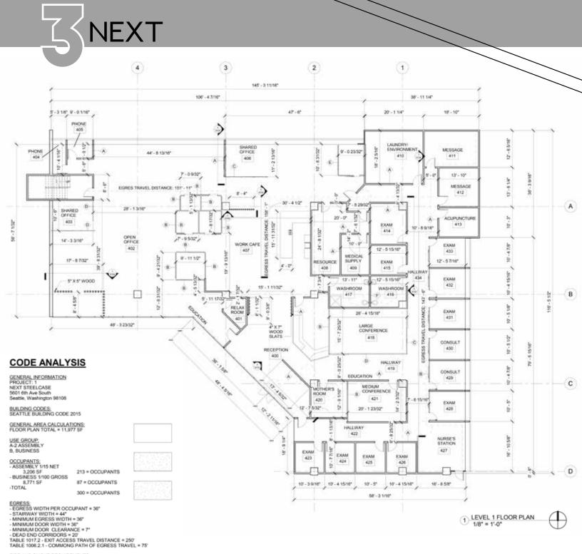
FIRE AND SMOKE REQUIREMENTS: AUTOMATIC FIRE SUPRESION SYSTEM - YES FIRE ALARM SYSTEM - YES
